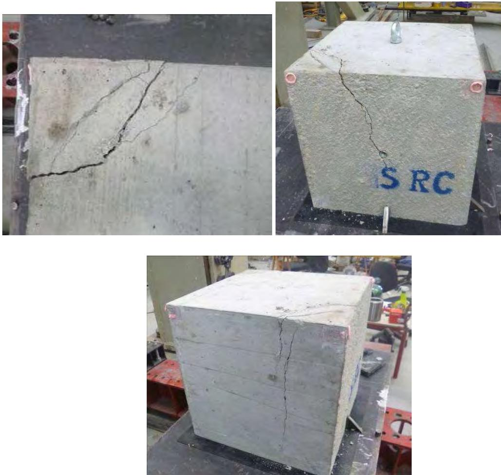
Figura 12. SRC. Termine della prova; spigolo 1 blocco inferiore
