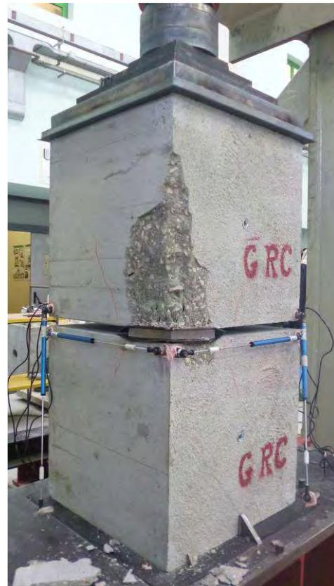
Figura 20. Prova 2 – GRC: Evoluzione quadro fessurativo spigolo 1.
