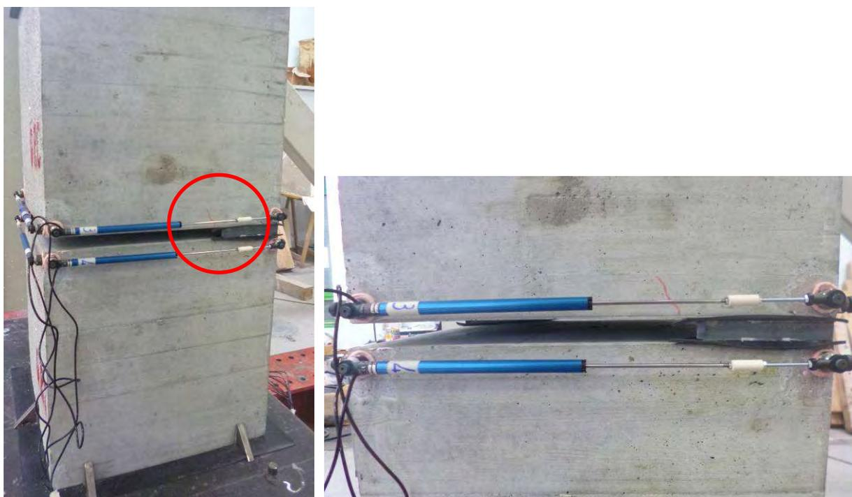
Figura 16. Prova 2 – GRC: Formazione delle prime fessure - superficie destra, spigolo 2(Fig. 5).
