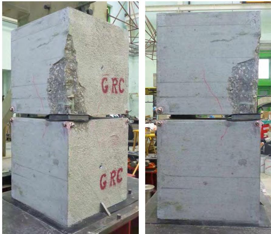
Figura 22. Prova 2 – GRC: Termine della prova: superficie di rottura spigolo 1 (Fig. 5)
