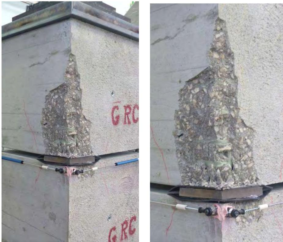
Figura 20. Prova 2 – GRC: Superficie di rottura – spigolo 1 (dettaglio).
