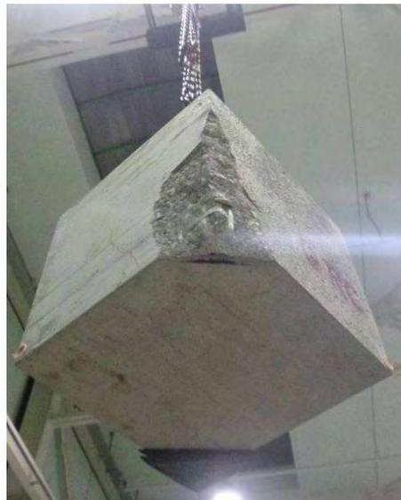
Figura 24. Prova 2 – GRC: Superficie di rottura blocco superiore - spigolo 1 (Fig. 5)
