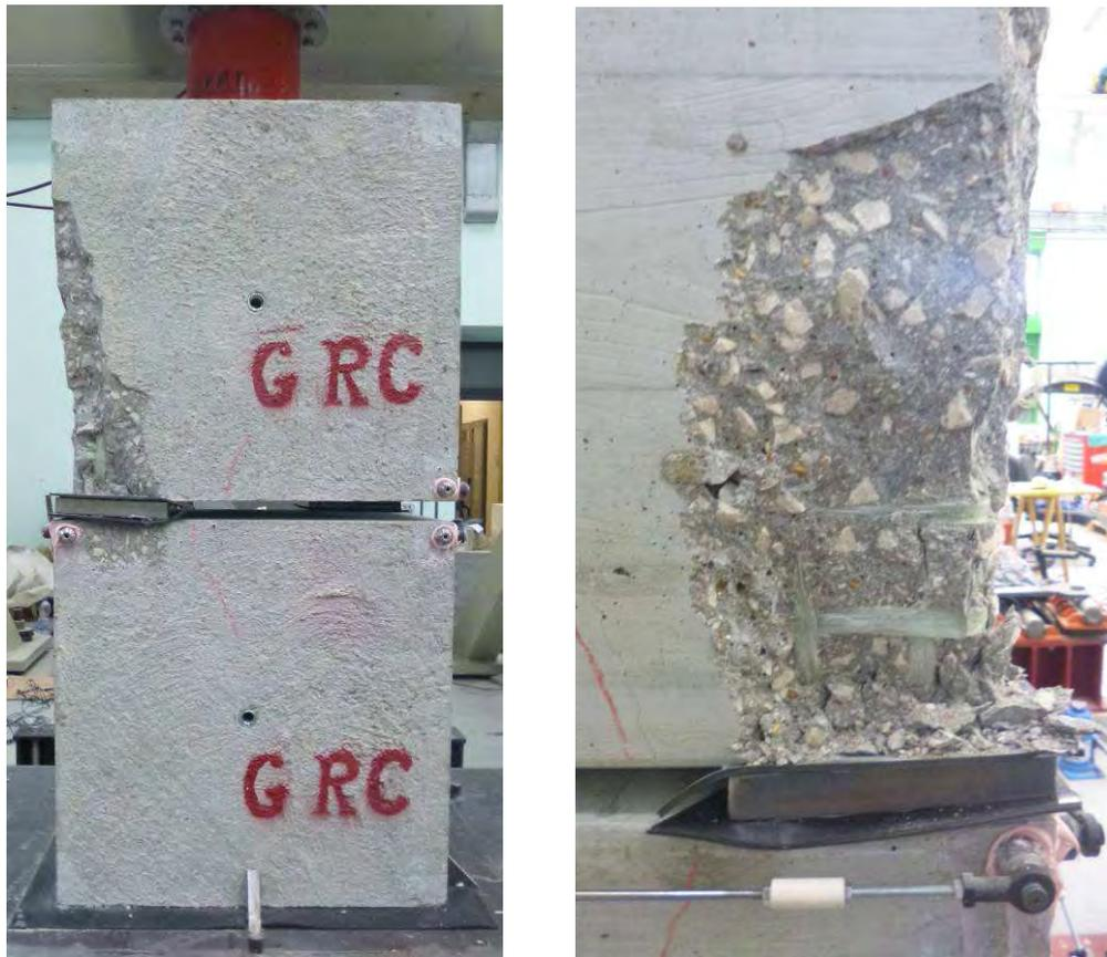
Figura 21. Prova 2 – GRC: Superficie di rottura – spigolo 1 – condizione ultima
