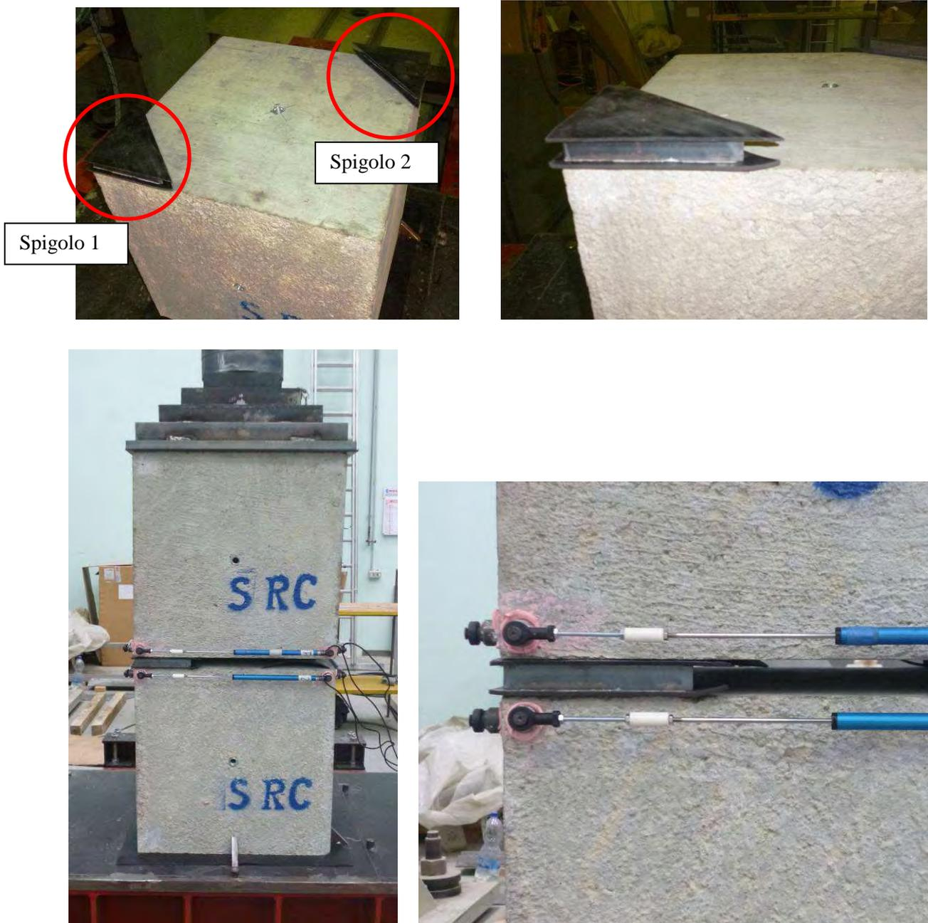
Figura 5. Setup di prova del sistema di contatto dei due conci e strumentazione
